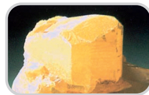
При комнатной температуре устойчивой формой серы является ромбическая сера.
