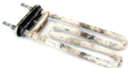
Накипь, образовавшаяся на нагревательном элементе.
