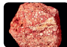
Боксит – основная руда алюминия. Основным компонентом боксита является оксид алюминия.
